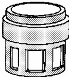
شكل ٤-٤- شیر با پیستون تریم - قفسه تک ورودی
